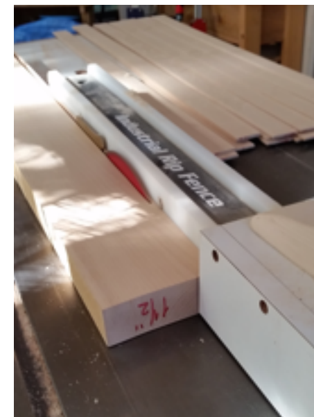
חיתוך הלוחיות במסור שולחני שמרתי על סדר בחירת הלוחיות כדי שייראו כהמשך רציף לחתך העץ.
