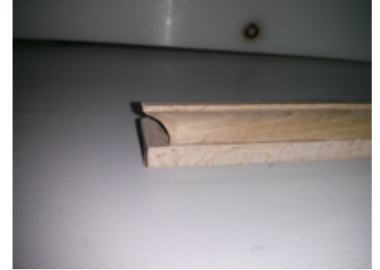
קצה המוט מכורסם בקצה לרבע עיגול. הלשונית שנותרה תשמש כסין
