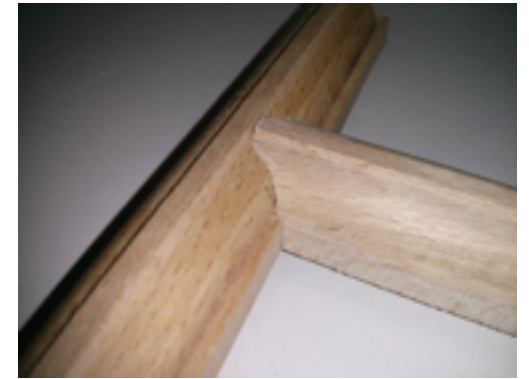
מוצמדים סופית. החיבור יציב (בתוספת דבק כמובן)
